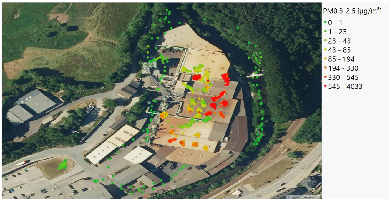
Abbildung A4- 5: Massenkonzentration (berechnet) von Partikeln der Größe 0,3-2,5 \mu\text{m} bei der orientierenden Messung am 09.05.2023
