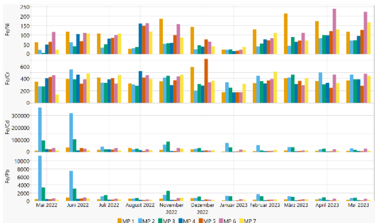
Abbildung A3- 1: Verhältnisse Fe/Ni; Fe/Cr; Fe/Cd; Fe/Pb im Staubniederschlag
