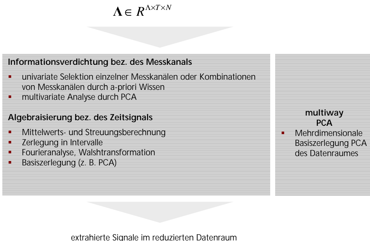
Abb. 5.4: Methoden der Signalextraktion
