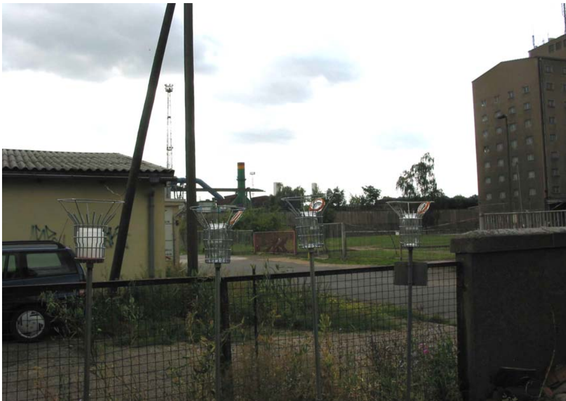
Abbildung 1: Messpunkt zur Staubbiederschlagsmessung mit vier Bergerhoffsammlern (Foto: Staatliche Betriebsgesellschaft für Umwelt und Landwirtschaft, Fachbereich Immissionsmessungen)
