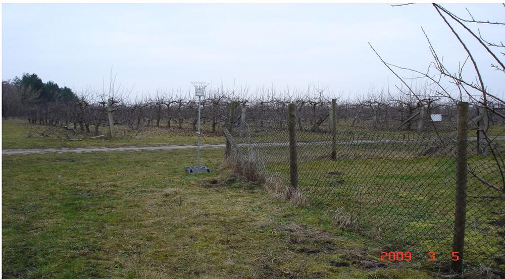
**Abb. 2: Messpunkt zur Staubbiederschlagsmessung mit Bergerhoff-Sammler (Quelle: BfUL)**
