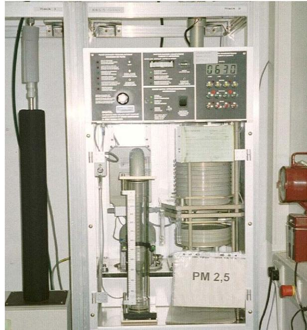
**Abb. 3.1-4:** PM<sub>2,5</sub>-Probenahmegerät (Digital DHA 80), Verkehrsstation.
