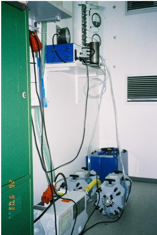
**Abb. 3.1-3:** MOUDI-Impaktor und Nano-MOUDI sowie 2 Membranpumpen der MOUDI Impaktoren und eine Drehschieberpumpe für Berner-Impaktor in der Verkehrsstation.
