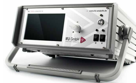
Iontově mobilizační spektrometr Zdroj: IFU GmbH [Práva pro použití v brožuře udělena písemně]
