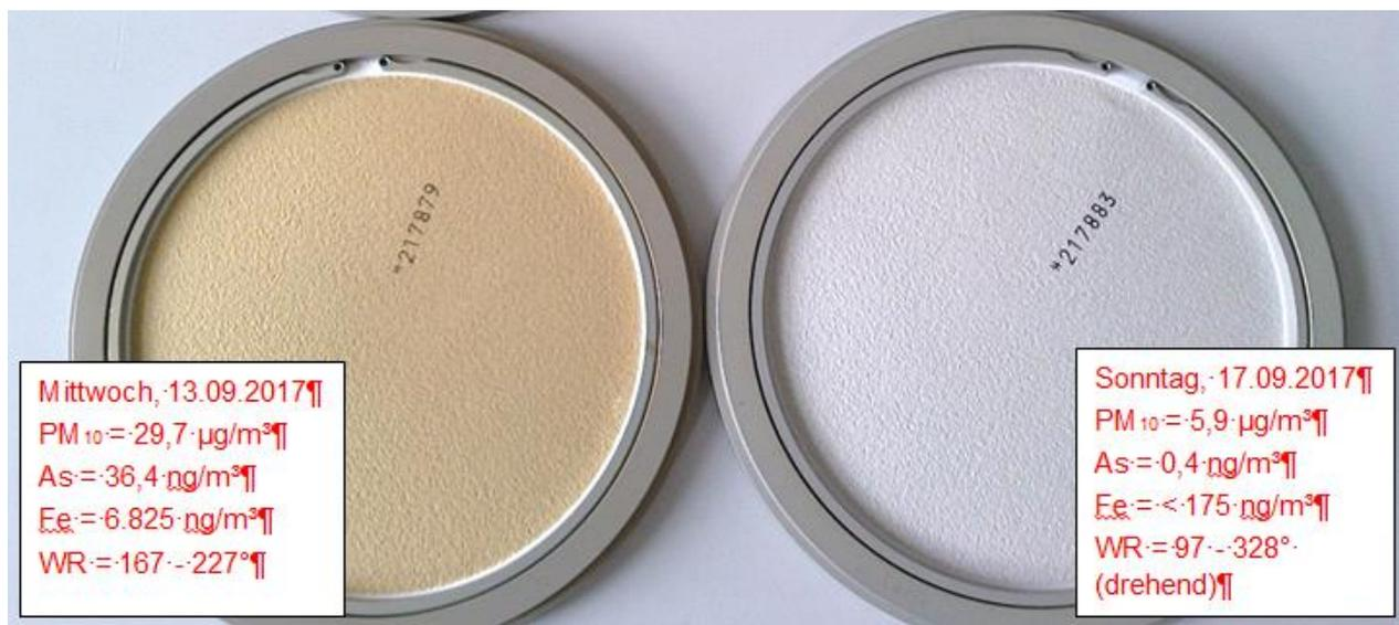
**Abbildung 6: Optische Befunde: Filter links - bei südlicher Anströmrichtung aus Richtung Schrottplatz, im Vergleich dazu Filter rechts – sonntags, bei drehenden Winden**
