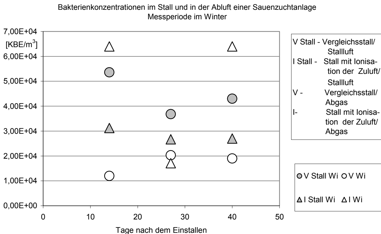
Abb. 6: Bakterienkonzentrationen im Stall und in der Abluft einer Sauenzuchtanlage
