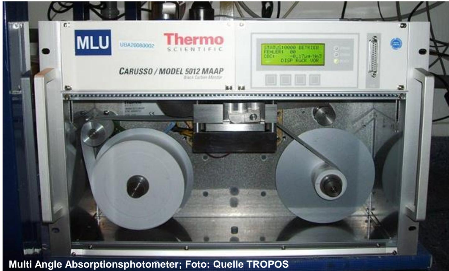
Multi Angle Absorptionsphotometer; Foto: Quelle TROPOS
