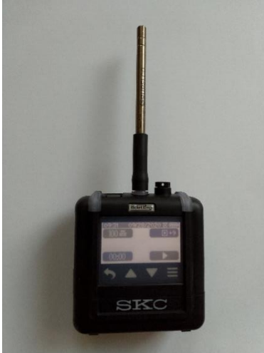
Abb.1: Vorrichtung zur Erfassung der VOC-Komponenten - Probenahme auf Tenax
