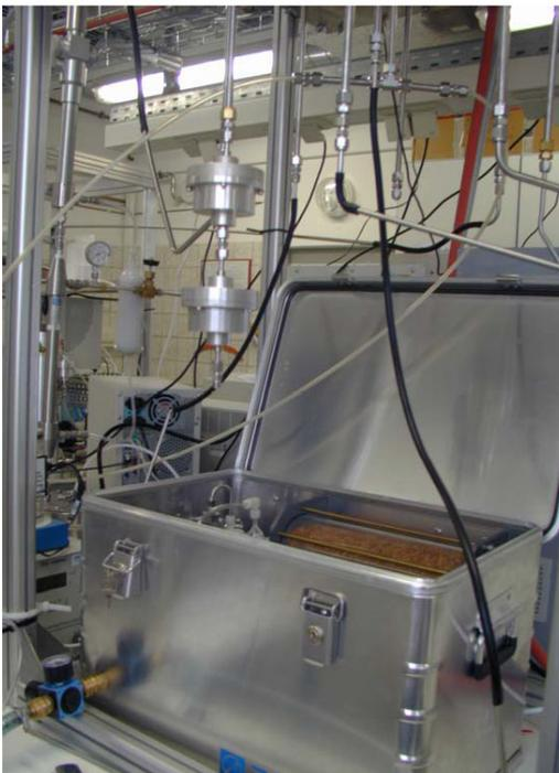
**Abb. 2.3.2: Messaufbau im IfT-Labor: TDMP5-IfT und TDMP5-DD-Nord (oben links), TSI 3031 und UFP 330 (oben rechts), SMPS-IfT (unten links), Aerosolerzeugungseinheit (unten rechts).**
