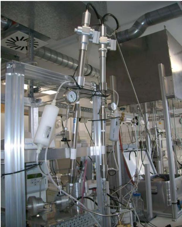
**Abb. 5.1: Zwei Probenahmesysteme vom Typ 3031200 während Messungen mit dem UFP 330 und TSI 3031 an der großen Mischkammer.**
